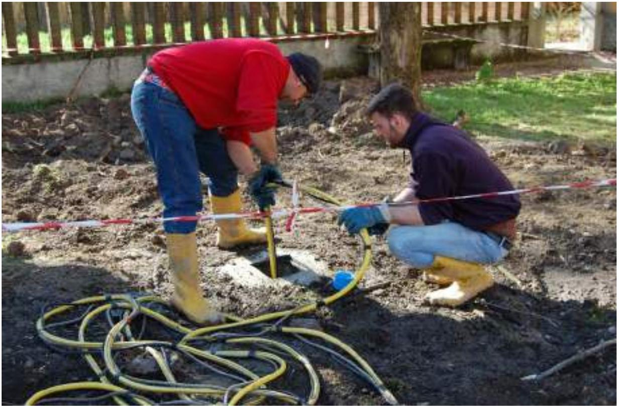
*Fasi di immissione della pompa nel piezometro per lo spurgo*
