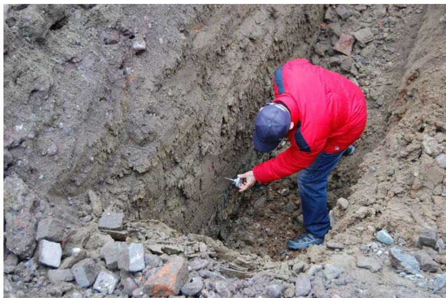
*Esecuzione delle indagini geotecniche speditive condotte sulle pareti delle trincee*
